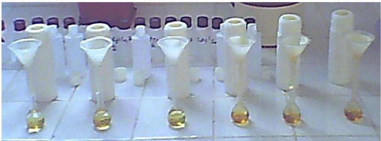
Figure 15 : Filtration du contenu des bombes à téflon dans des fioles de 50 ml.
