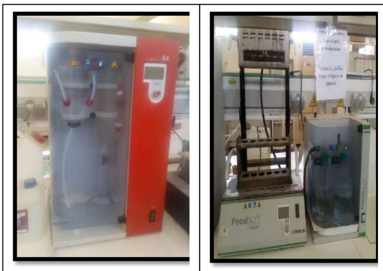
**Appareils de distillation à la vapeur kjeldahl**
